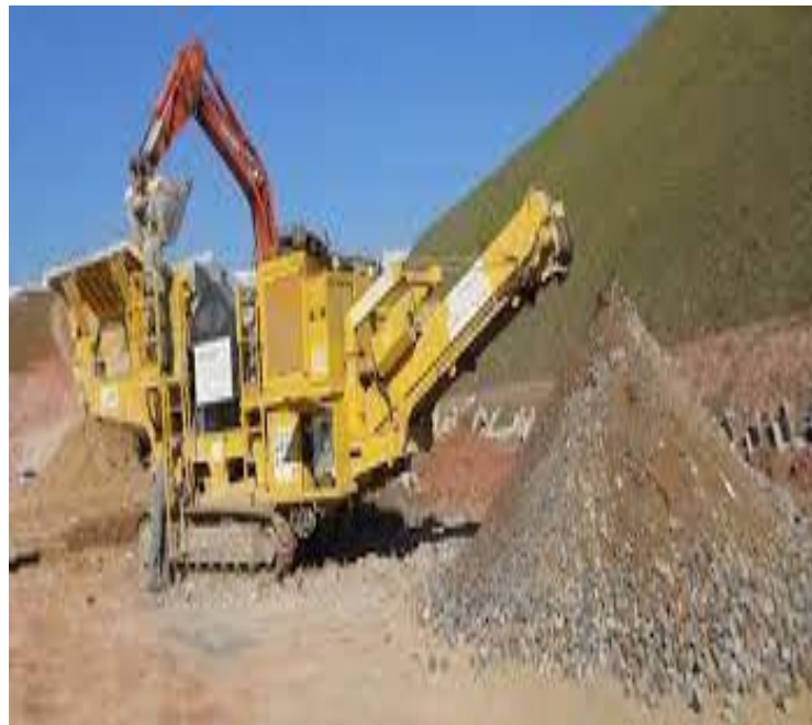
Figura 09- Processo de Cominuição ou britagem
