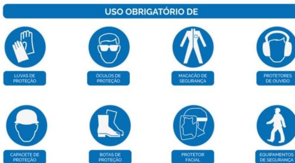
Figura 2: Sinalização de obrigação
