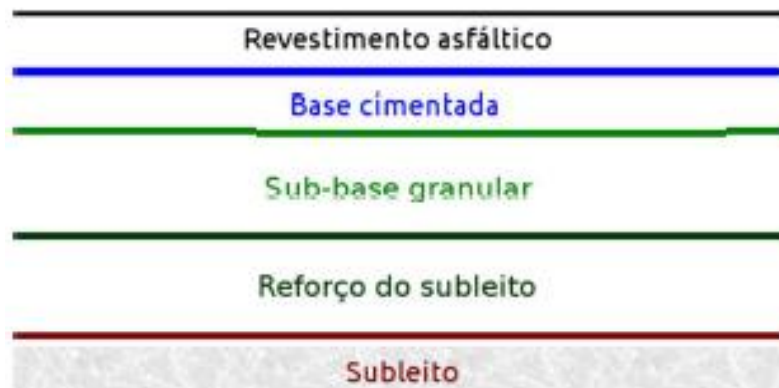
Figura 4 – Estrutura de Pavimento Semirrígido
