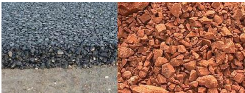
Figura 7 - Macadame hidráulico e seco
