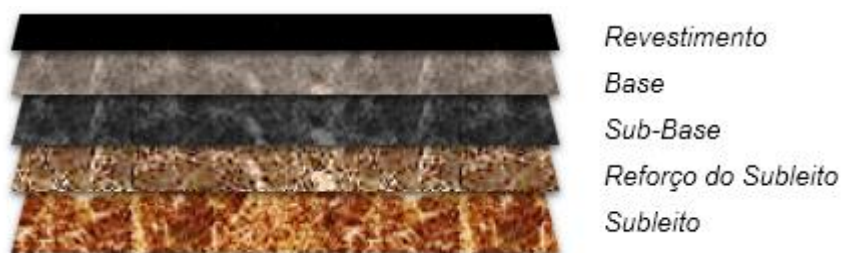
Figura 5 – Pavimento flexível, camadas
