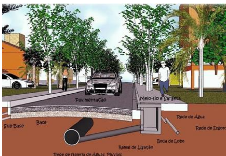
Figura 5 - Rede de galeria de águas pluviais
