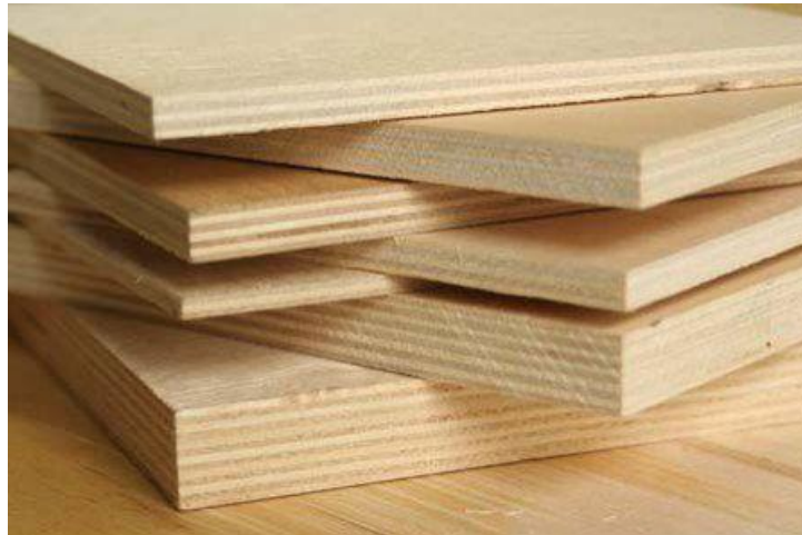
Figura 2 – Pranchas de compensado para uso em fôrmas.
