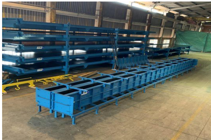
Figura 3 – Forma metálica para pilar.
