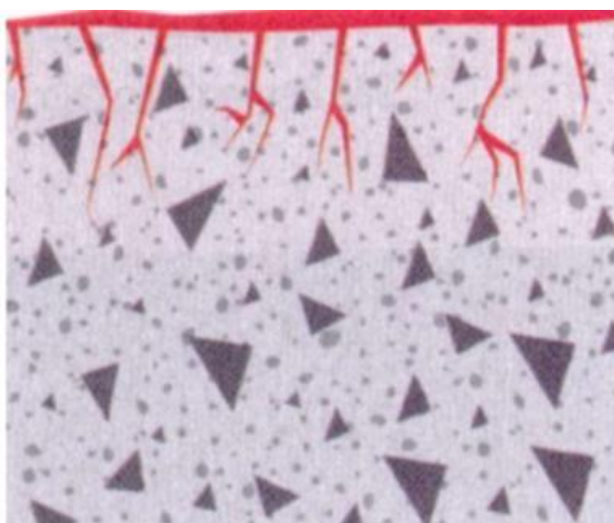
Figura 18 - Cristalização superficial do substrato
