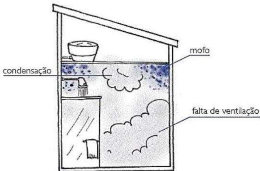
Figura 14. Vapor de água sofrendo condensação no teto de uma residência
