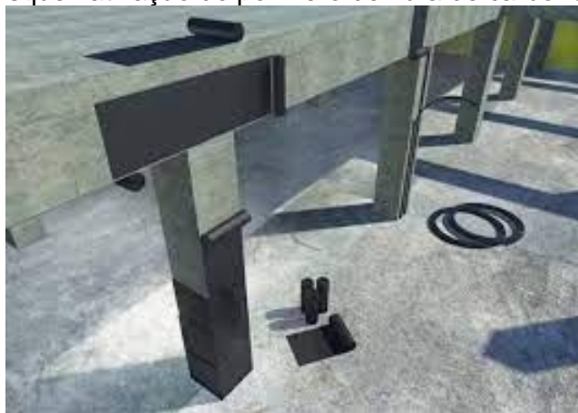
Figura 15 - Esquemática do polímero de fibra de carbono em um pilar
