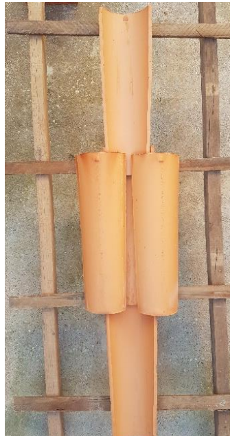
Figura 4-b: Determinação do rendimento médio da telha colonial
