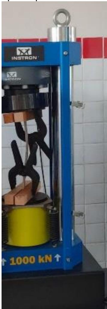
Corpo-de-prova 2 após ruptura.
