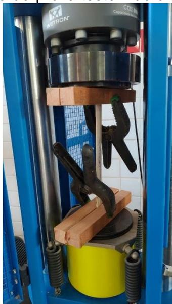
Corpo-de-prova teste deformado.
