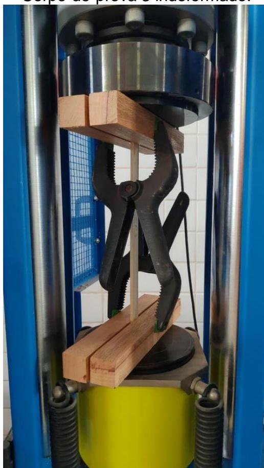
Corpo-de-prova 3 deformado.
