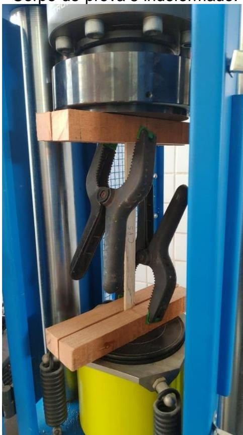
Corpo-de-prova 5 deformado.
