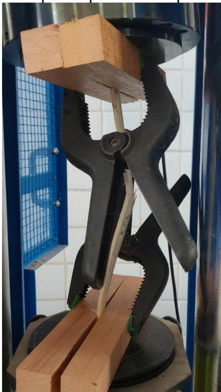
Corpo-de-prova 2 na prensa indeformado.
